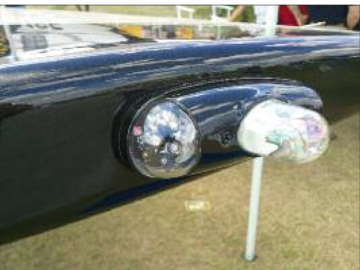
Zwykłe żarówki zastąpiono diodami LED nie tylko w oświetleniu pozycyjnym...
