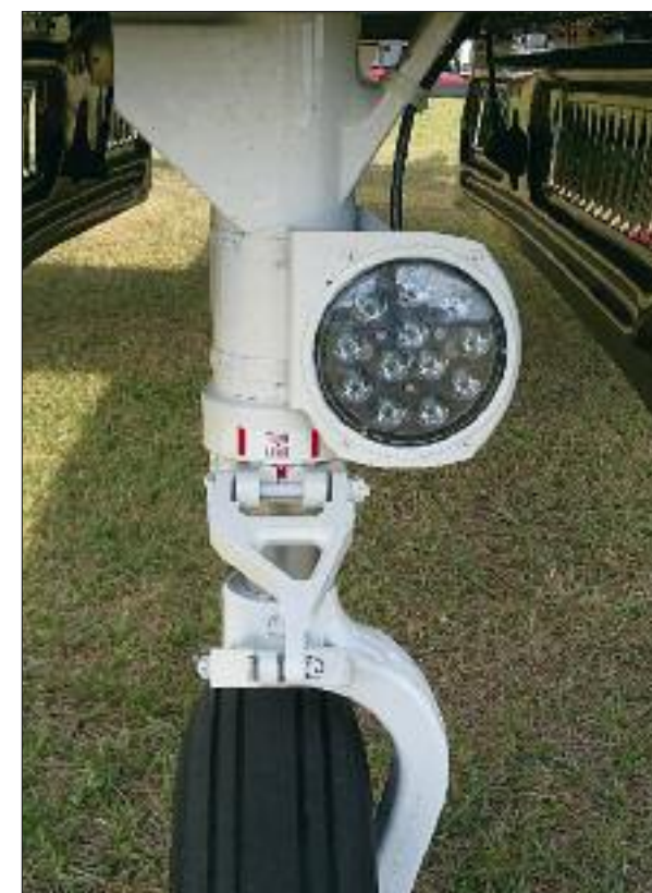
Podwozie w M-Class pozwala na operowania z nietwardzonych lotnisk
